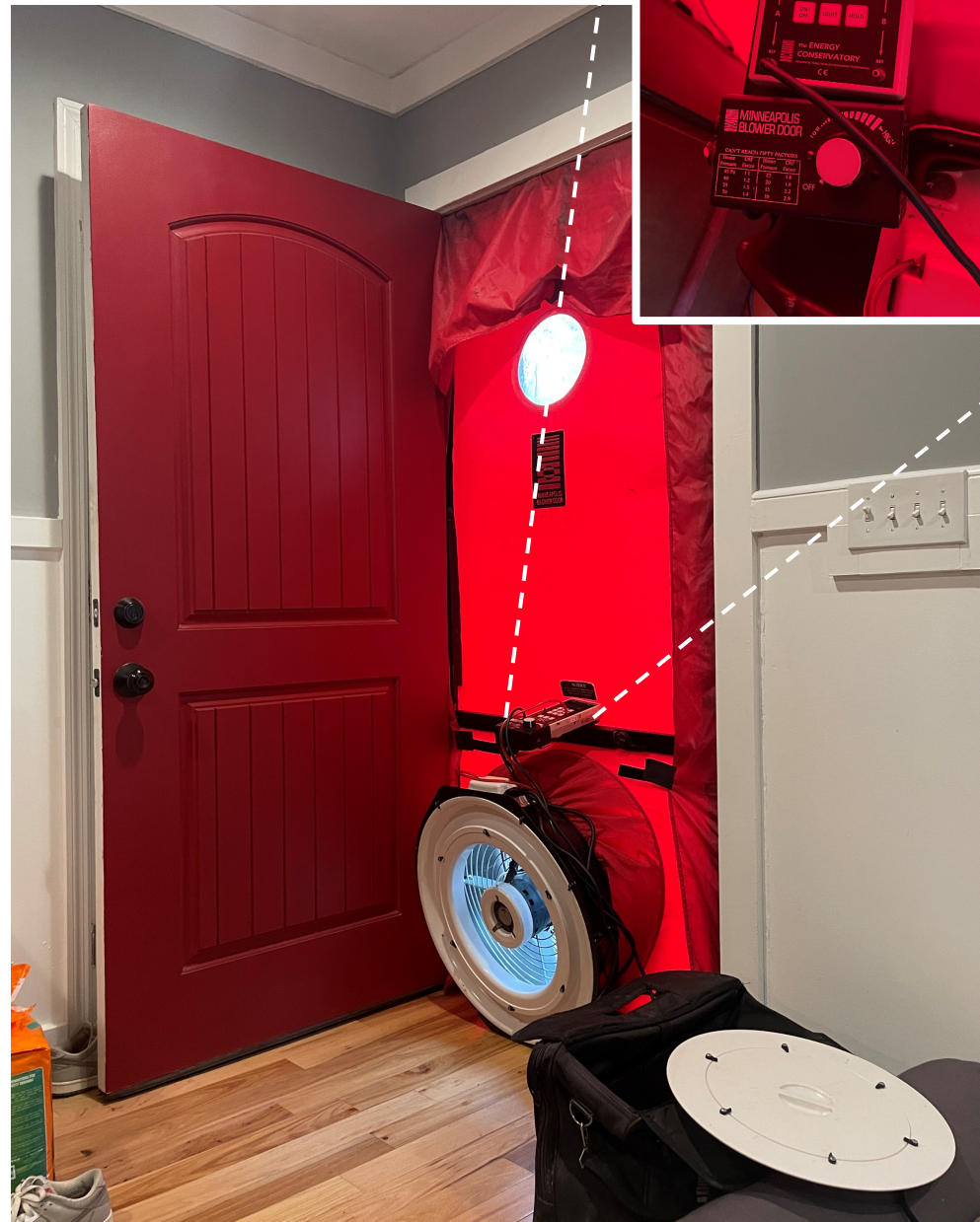
Blower Door Test
